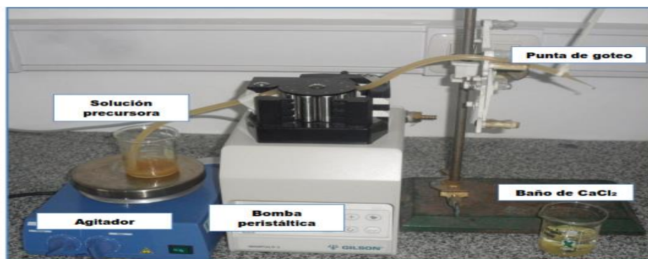
Figura 3. Montaje empleado a nivel laboratorio en la obtención de cápsulas por gelificación iónica usando una bomba peristáltica.
