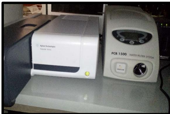
Figura 9. Espectrofotómetro Cary 60 UV Vis.
