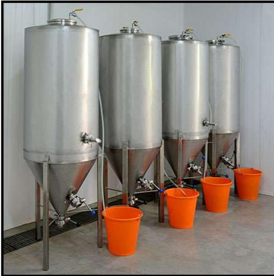
**Figura 1. Tanque de fermentación.**
