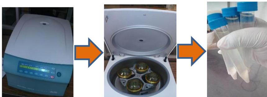
Figura 17. Obtención del paquete celular.
