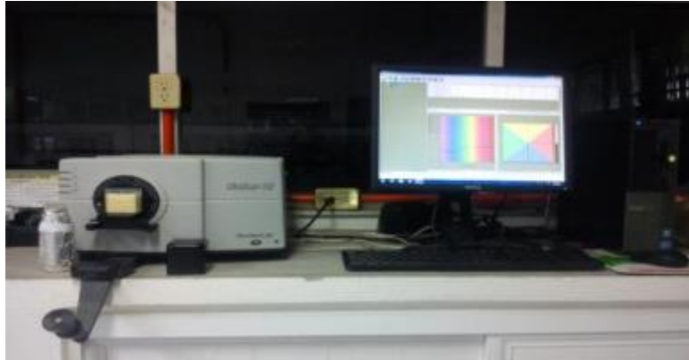
Figura 13. Colorímetro Ultra Scan Vis Hunter Lab.
