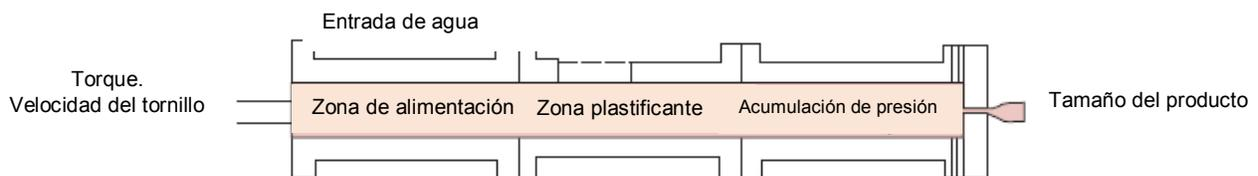
**Figura 7.** Componentes de un extrusor simple (Singh y Heldman, 2014).
