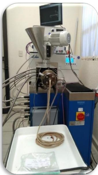
**Figura 13.** Fotografía del extrusor de tornillo simple.
