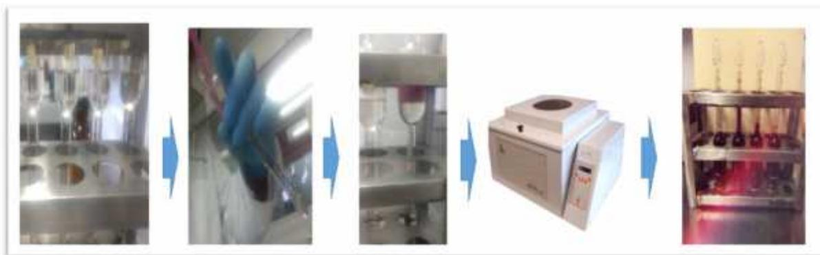
**Figura 24** Determinación de grasas por el método Gerber.
